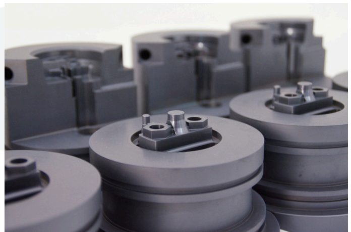
B-Protect-beschichtetes Kunststoff-Spritzwerkzeug mit 8 Spritznestern
