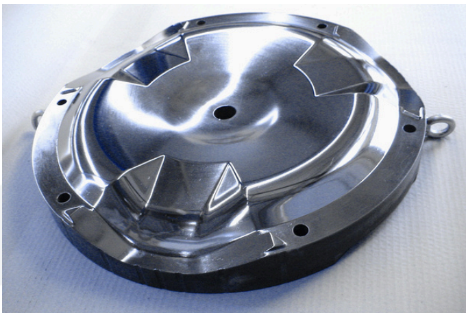
CrN-beschichtetes Umformwerkzeug zur Felgenreueherstellung
